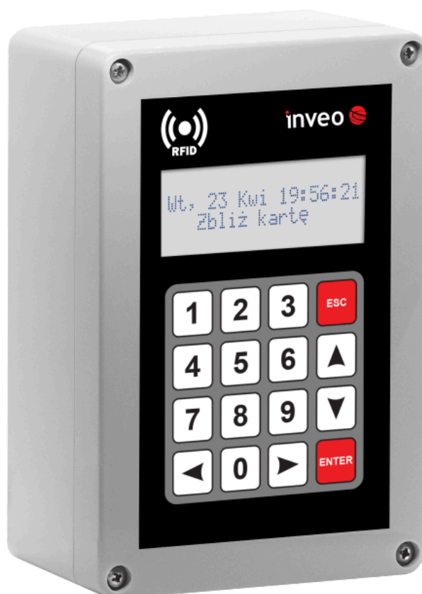
Wygląd ogólny modułu RFID RCP2 z klawiaturą numeryczną
