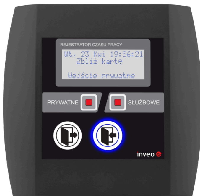
Wygląd ogólny modułu RFID RCP2 z klawiaturą numeryczną
